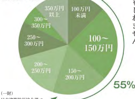
木造住宅の耐震改修の費用
