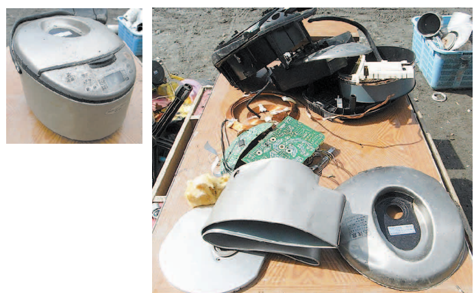
この製品の場合、本体や蓋が金属部品（写真手前）とプラスチック（写真奥）に分かれました。写真中央は、基板と銅線で、これらも金属類として資源になります。
