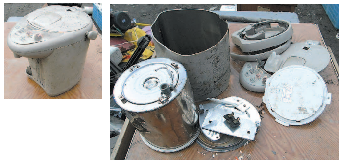
ボルトをはずすなどしてできる限り丁寧に解体してください。この製品の場合、給湯部がプラスチック（写真右側）と本体の金属（写真左側）部品に分別しました。
