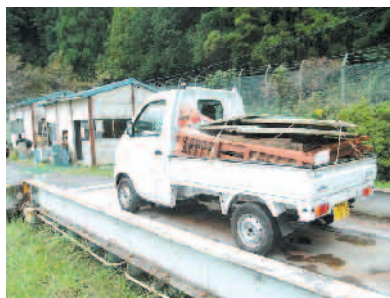
写真右：ごみを下ろす前後2回計量し、差引重量から料金を提示します。 写真左：作業員は搬入されたごみの重量を計量機で測り記録します。
