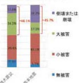
昭和56年5月以前に建築された建物の被害の割合
