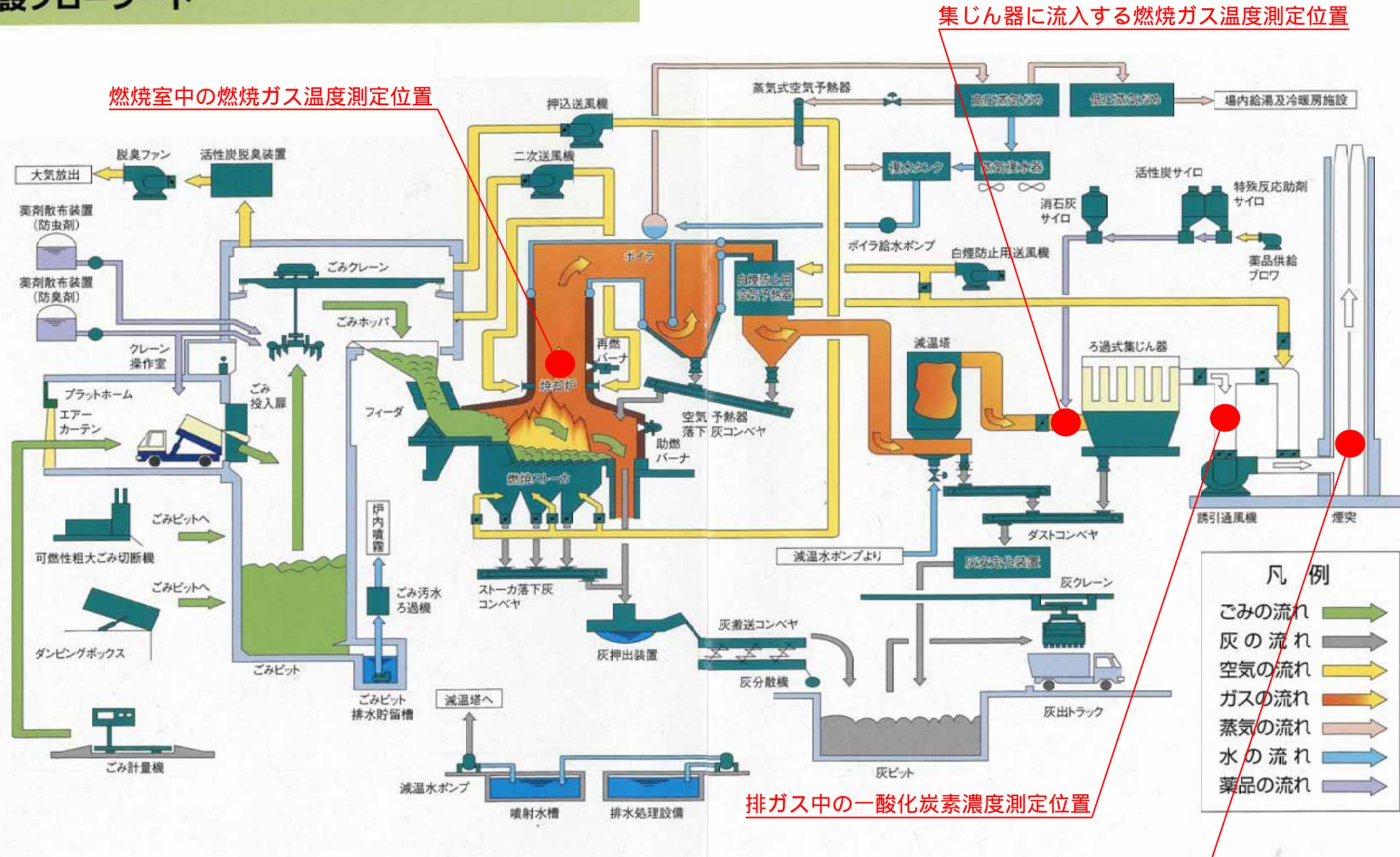
燃焼室中の燃焼ガス温度測定位置
