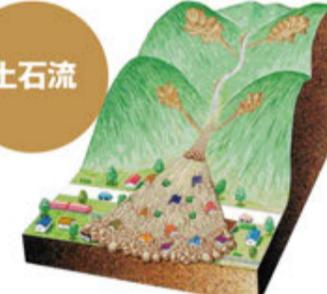
大雨などで山の斜面が崩れたり谷底にたまった土砂が流れ出したりしたときに、水と土砂が混ざりあってもすこい勢いで谷から流れ出す現象です。
