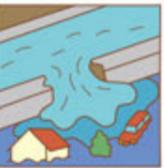
大雨等で河川の水位が上昇し、堤防が決壊したり、河川の水が堤防を超えたりすることにより起こる氾濫を外水氾濫(洪水)といいます。
