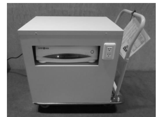
⑦蓄電池 最大出力600W コンセント2カ所
